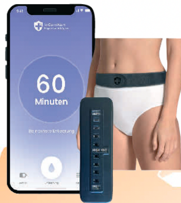
Ein Gurt, ein Sensor am Schambein: Die Technik von inContAlert sagt, wann es Zeit ist, die Toilette aufzusuchen.
