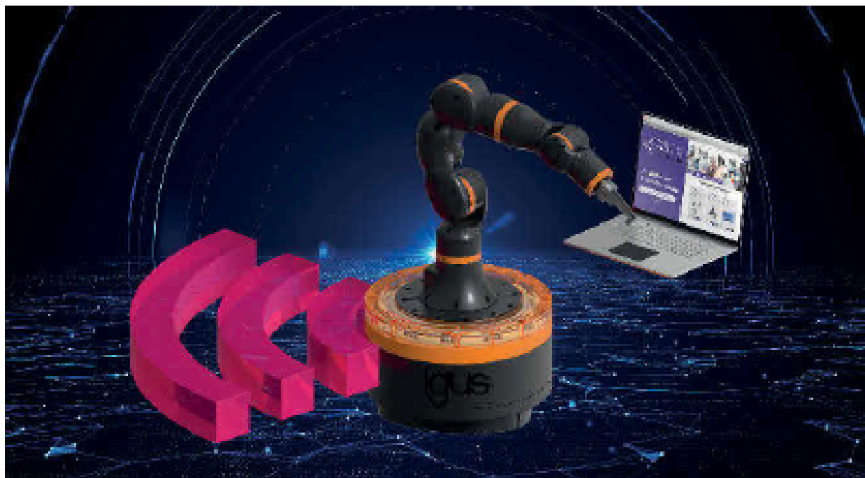
Bild 2. Der „ReBel“-Gelenkarmroboter besteht zu einem Großteil aus Hochleistungskunststoff. Er kostet 4970 € und lässt sich laut igus ohne Programmierkenntnisse zu einer vollständigen Automationslösung inklusive Greifer, Vision-Systeme und Steuerungen konfigurieren. Foto: igus GmbH
